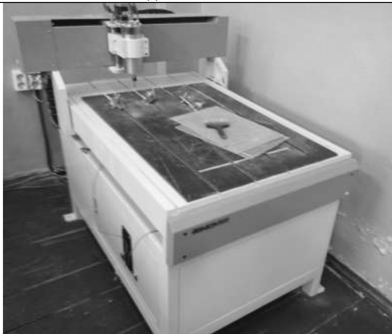
Рис.1.1. Фрезерно-гравірувальний верстат із числовим програмним керуванням STO CNC-6090
