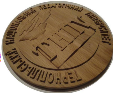
Рис. 3. Результат виконання управляючої програми на станку.
