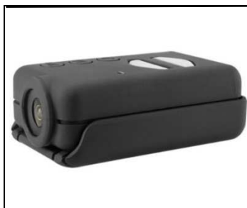
Рис. 1. Модифікована відеокамера для отримання БІЧ ділянок спектра Mobius Action Cam-Infragram [10]
